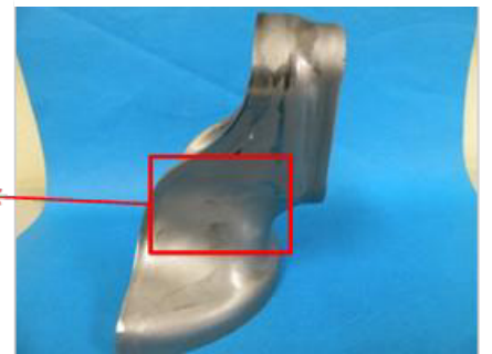
OX-FSP/OX-POLISH処理をして プレスした製品
